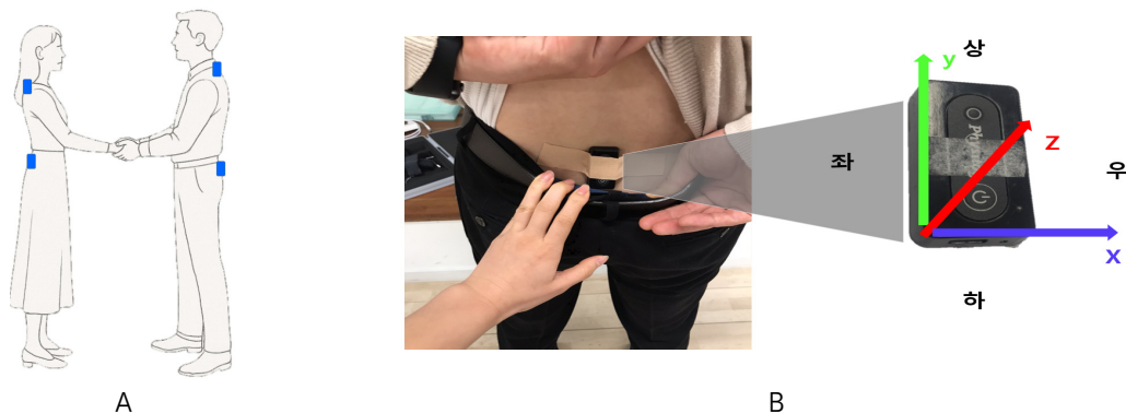
그림 1. 남녀 댄서에 부착된 센서의 위치(A)와 골반 관성센서 3축의 정의(B)
